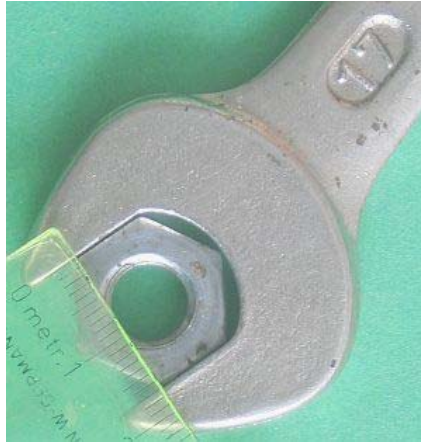
Abb. 2.3.1.5: Schlüsselmaß einer 17er-Mutter
