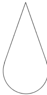
Abb. 9.2.2.2: Militärperspektive eines Kegels
